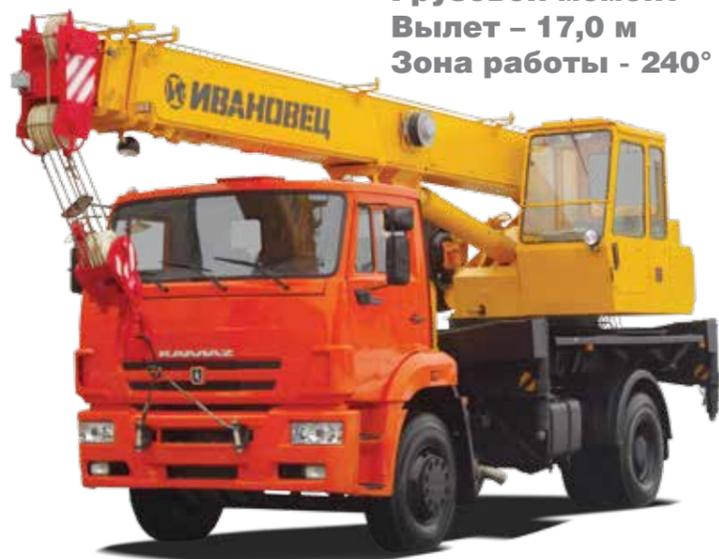
Автомобильный кран КС-35714К-2, грузоподъемностью 16 тонн, смонтирован на шасси КАМАЗ-53605 (4x2).
